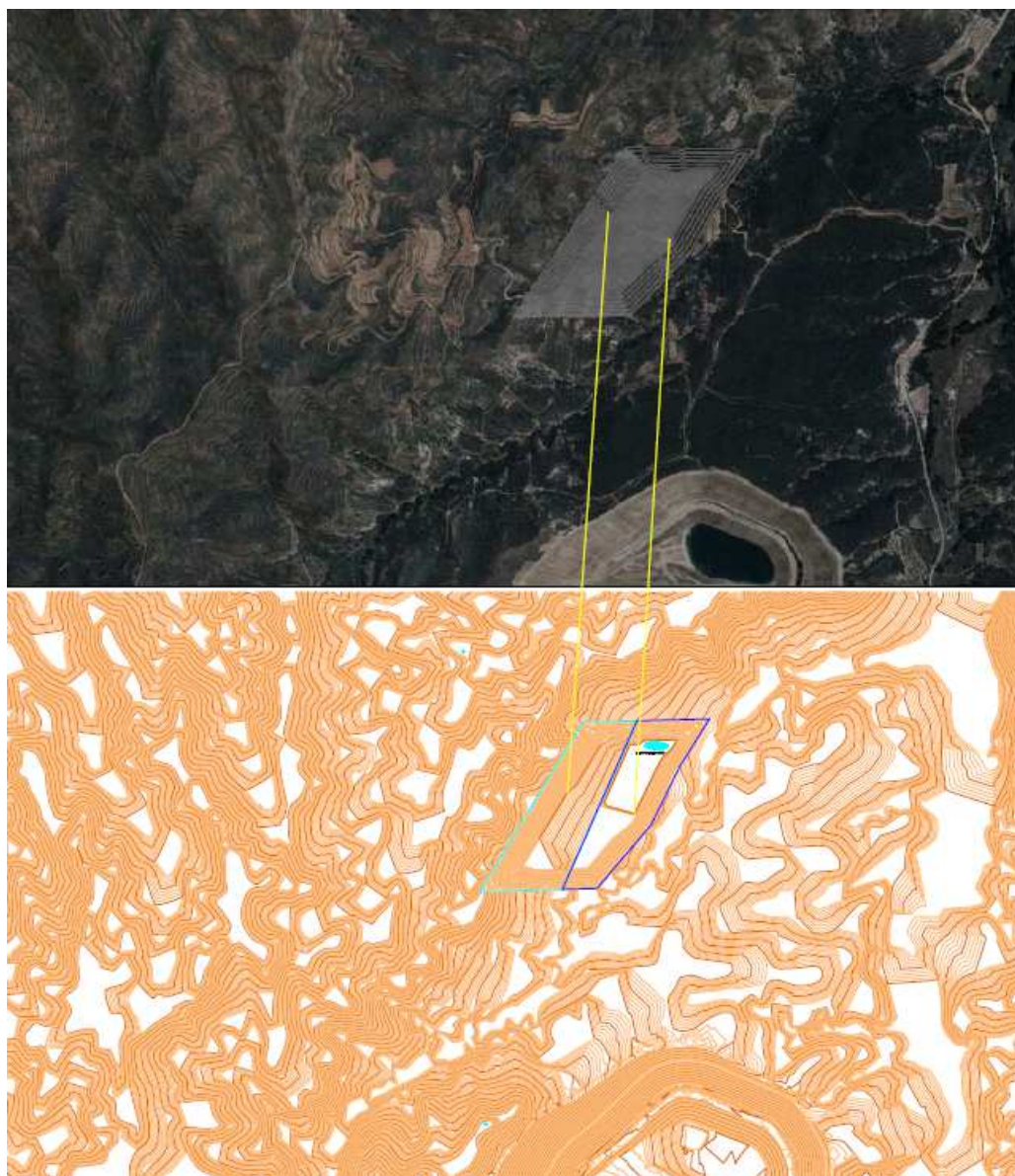
Figura 13. Simulación 3D y curvado de situación del hueco teórico de explotación tras la explotación de la Fase II (en azul) y de la Fase I (en cian) y sus correspondencias mediante líneas en amarillo con la simulación.
