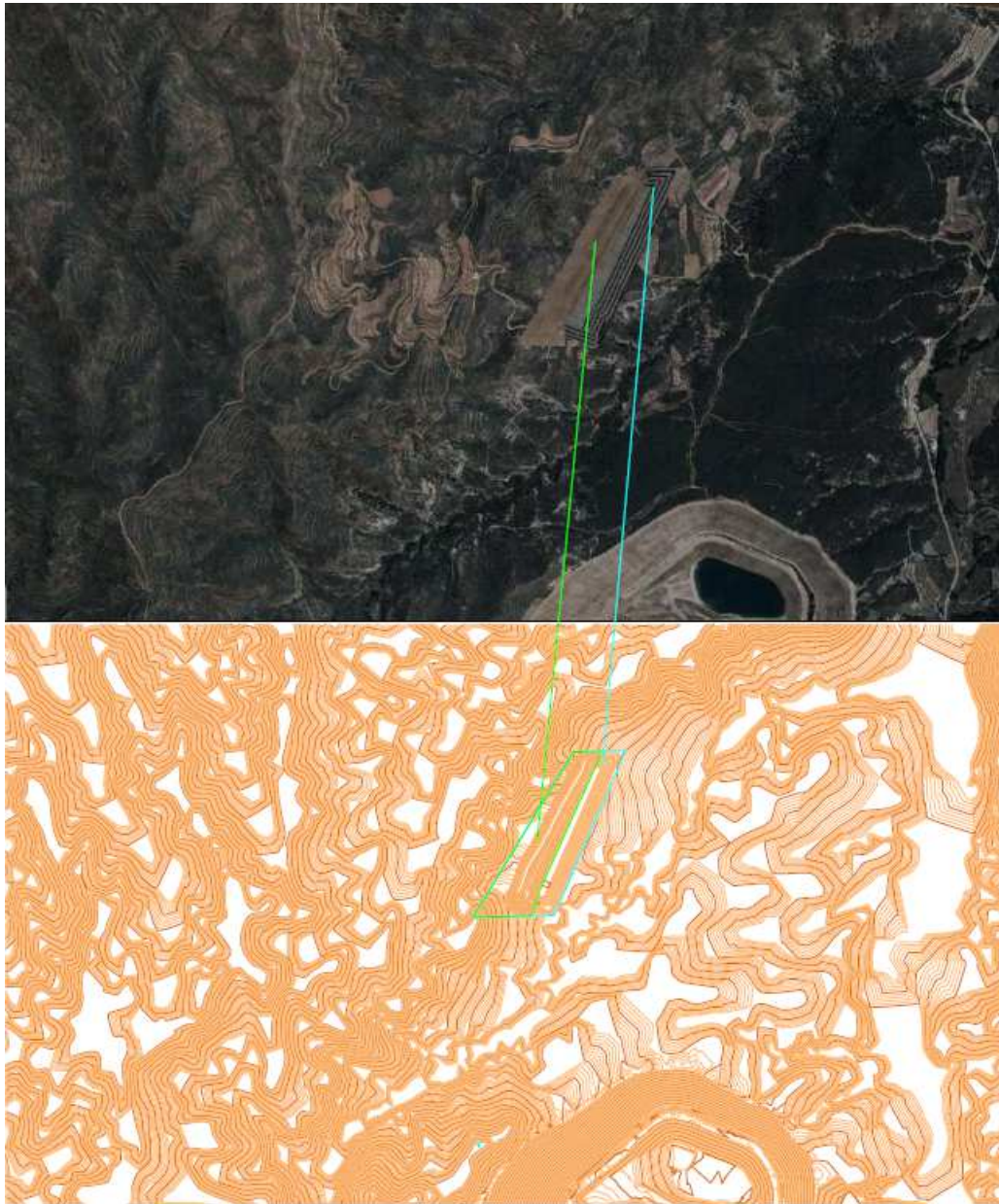
Figura 19. Simulación 3D y curvado de situación del hueco de explotación tras la restauración de la Fase I (trama marrón en la simulación y perímetro en verde en el curvado) y toda la zona en explotación (trama en gris en la simulación y perímetro en cian en el curvado) y sus correspondencias mediante líneas en cian y verde respectivamente con la simulación.
