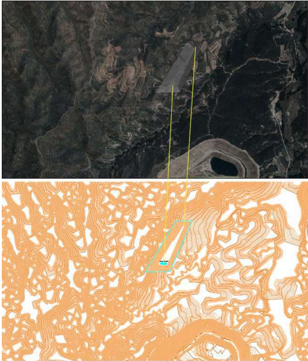
Figura 9. Simulación 3D y curvado de situación tras la explotación de la primera parte de la Fase I de explotación, donde se puede observar la creación del hueco de explotación (perímetro azul) y su correspondencia con la simulación mediante líneas amarillas. La trama en azul es la balsa de agua situada en el fondo de la corta.
