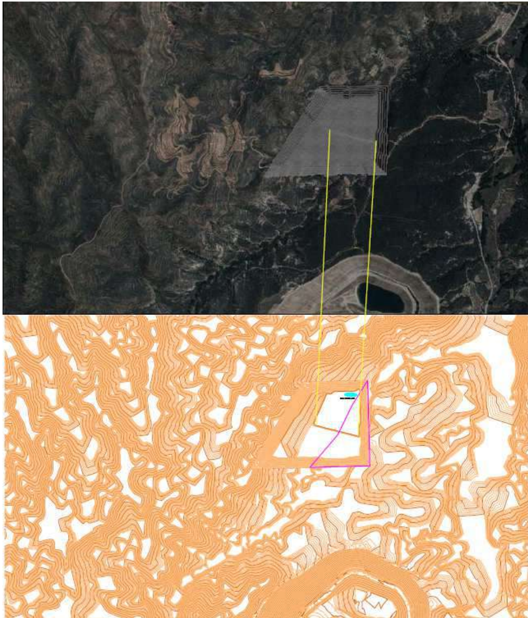
Figura 16. Simulación 3D y curvado de situación del hueco teórico de explotación tras la explotación de la Fase III (trama marrón en la simulación y perímetro en magenta en el curvado) y el resto del hueco teórico de explotación y sus correspondencias mediante líneas en amarillo con la simulación.
